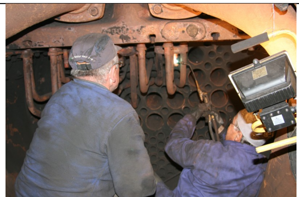
Démontage des éléments surchauffeurs
